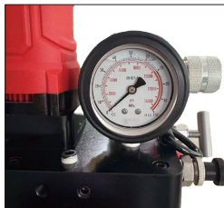
系统空载状态下，确认压力表初始读数为零。
