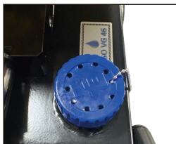
安装排气堵头
