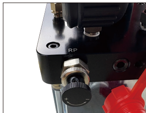
顺时针（‘+’号方向）缓慢转动调压阀。
