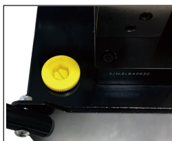
若油位低于 2/3，请将此出口油口堵头旋转取出后，进行加油操作。
