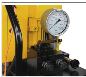
切换手控换向阀的位置实现泵系统的加压保压与卸荷。
