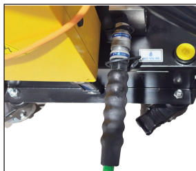
外锁环后退，油管轴向对正完全推入出油口
