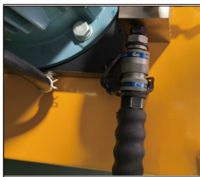
外锁环后退，油管轴向对正完全推入出油口。
