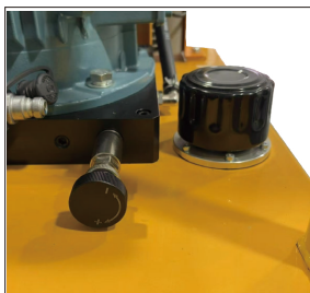
拧松锁定螺母调节溢流调压阀。
