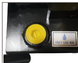
若油位低于上油位计 2/3 刻度线，需旋出油口堵头，执行液压油补充操作
