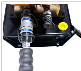
推入油管后，将外锁环前推，顺时针旋转锁定
