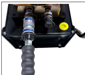
外锁环后退，油管轴向对正完全推入出口
