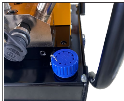
安装排气堵头
