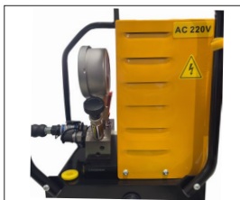
检查电控箱体，确定额定电压。
