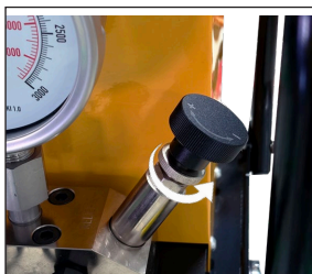
拧松锁定螺母调节溢流调压阀。
