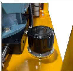
若油位低于 2/3，请将此出口堵头旋转取出后，进行加油操作。
