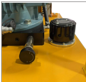
拧松锁定螺母调节溢流调压阀。
