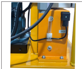
检查电控箱体，确定额定电压。
