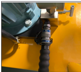
外锁环后退，油管轴向对正完全推入出口口。
