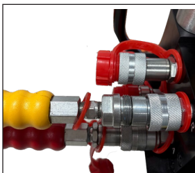
油管轴向对正完全推入出油口
