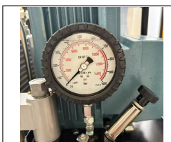
系统空载状态下，确认压力表初始读数为零。
