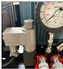
通过手柄上的电磁阀控制按钮，实现对系统油液流向的精准控制。
