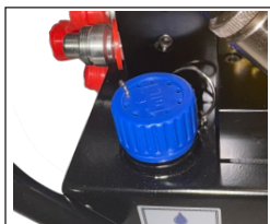
安装排气堵头
