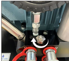
回程压力通过 R 口限压阀进行调节
