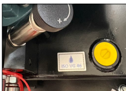
若油位低于 2/3，请将此出油口堵头旋转取出后，进行加油操作。
