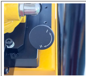
松开溢流阀上的锁紧螺母，顺时针缓慢旋转溢流调压阀，使 A 口达到目标压力
