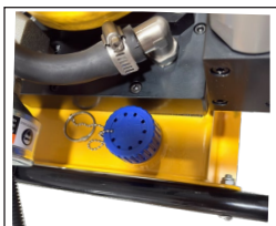
安装排气堵头
