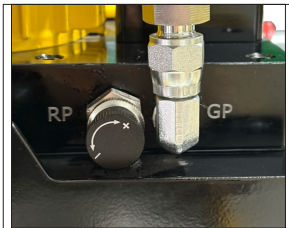
顺时针（'+' 号方向）缓慢转动调压阀
