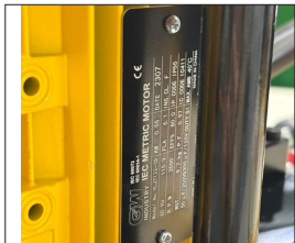
检查泵体铭牌，确认标注电压 115V/60HZ
