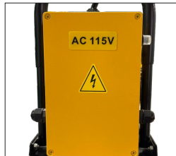
电控箱贴有电压提示标识 (AC115V)
