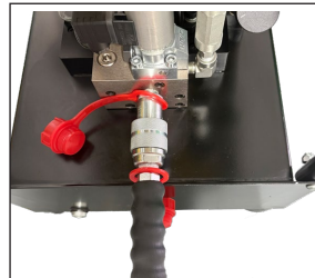
推入油管后，将外锁环前推，顺时针旋转锁定
