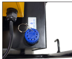
安装排气堵头
