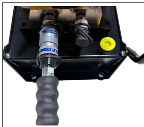
外锁环后退，油管轴向对正完全推入出口口。
