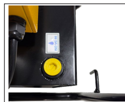
若油位低于 2/3，请将此出口口堵头旋转取出后，进行加油操作。
