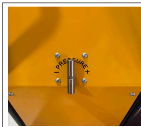
卸压时缓慢打开卸荷阀，将系统压力降低到压力表示数 0。
